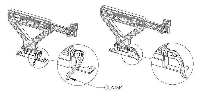
**STEP 4:** ROTATE THE SCREEN SUPPORT BACKWARDS.
